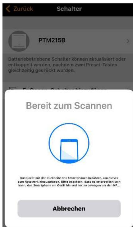
8. Sobald der Schalter erkannt worden ist wird er im Schaltermenü angezeigt und kann den Leuchten im Netzwerk zugeordnet werden
