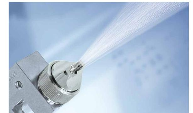
Alle gängigen feststoffarmen No-Clean Flussmittel aus dem Hause Stannol lassen sich mit allen auf dem Markt üblichen Sprühverfahren in geringsten Mengen reproduzierbar auftragen.
