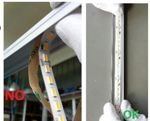
Der **Wärmeausdehnungskoeffizient** des Moduls beträgt  $17 \cdot 10^{-6} / \text{cm/cm/K}$ . Bei grossen Temperaturschwankungen wie im Aussenbetrieb und dem Betreiben von Längen grösser 2m sind metallische Befestigungsflächen zu verwenden oder zusätzliche Klebebänder mit einem zuverlässigen Halt, die die mechanischen Belastungen durch die unterschiedlichen Ausdehnungskoeffizienten in sich aufnehmen.
