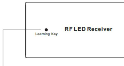
**Schritt 2:** Drücken Sie kurz den „Learning Key“ Knopf auf dem RF Empfänger oder schalten Sie den Empfänger drei mal hintereinander aus und wieder ein, um den Empfänger in den Verbindungsmodus zu versetzen.
