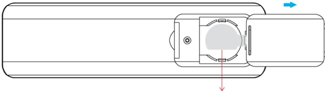
**Wichtig: Bevor Sie die Fernbedienung das erste Mal verwenden, ziehen Sie die Schutzfolie unter der Batterie raus!!**
