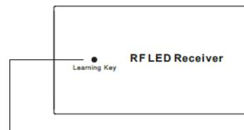
**Schritt 2:** Drücken Sie kurz den „Learning Key“ Knopf auf dem RF Empfänger oder schalten Sie den Empfänger drei mal hintereinander aus und wieder ein, um den Empfänger in den Verbindungsmodus zu versetzen.
