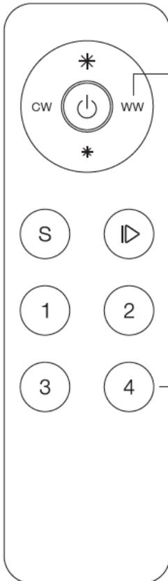
**Schritt 4:** Drücken Sie eine der Tasten CW, WW, heller, dunkler (im Bsp. WW). Die mit dem Empfänger verbundenen LEDs leuchten kurz auf. Die Fernbedienung ist nun mit dem Empfänger verbunden.
