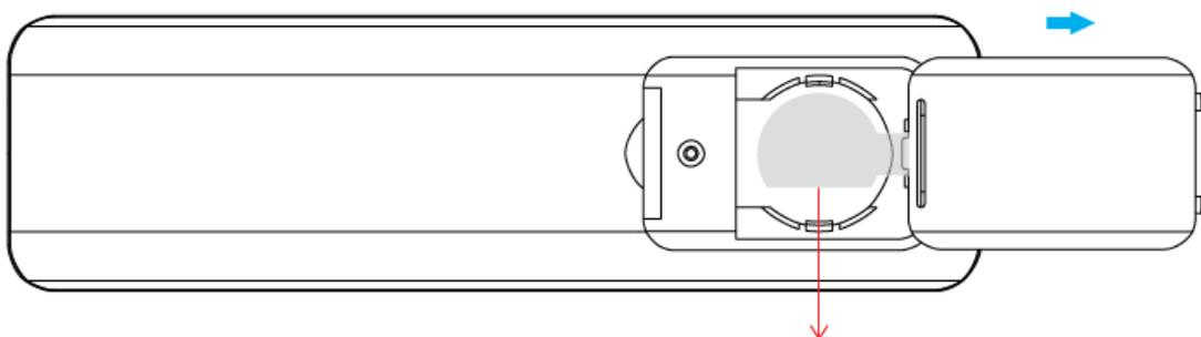
**Wichtig:** Bevor Sie die Fernbedienung das erste Mal verwenden, ziehen Sie die Schutzfolie unter der Batterie raus!!
