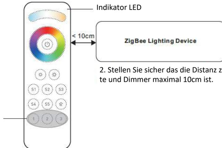
3. Drücken Sie und halten Sie eine der der Gruppen Tasten (1/2/3) gedrückt um den TouchLink Verbindungsmodus zu starten. Die Indikator LED blinkt langsam 6-mal hintereinander & die am ZigBee Gerät angeschlossenen Leuchte blinkt 2-mal um die erfolgreiche Verbindung anzuzeigen.
