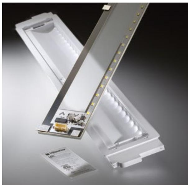
Als Weiterentwicklung des patentierten Produkts **IMPAtouch**<sup>®</sup> bietet Irlbacher nun mit **IMPAled** – LED on Glass ein neues Modul für lichttechnische Anwendungen an. Leiterbahnstrukturen werden auf das Glas gedruckt und die Bestückung der LEDs erfolgt direkt auf das thermisch gehärtete Substrat.
