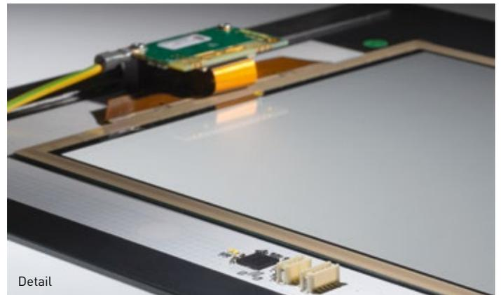
Unsere Produktlinie **IMPA**touch® ist erweitert. Wie bei Tablet-PCs bieten kombinierte Multitouchsensoren die Möglichkeit der Bedienung im Displayfeld, sowohl als tippende Bedienung von Buttons und Elementen, als auch z. B. das Ziehen von grafischen Elementen oder die Gestensteuerung.
