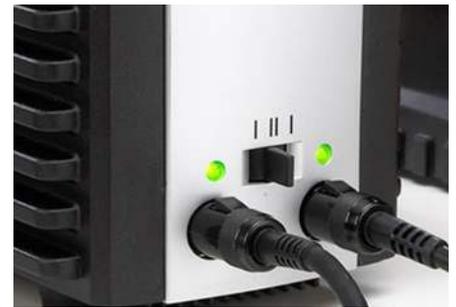
Kanalwahlschalter zur Aktivierung des linken oder rechten Kanals. Die Mittenposition aktiviert beide Kanäle
