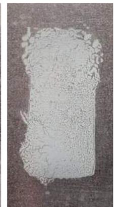
Die Fotos zeigen die Leistungsunterschiede zwischen den verschiedenen nicht-härtenden thermischen Interface-Materialien, nach erfolgtem thermischen Schock-Test zwischen  $-40^{\circ}\text{C}$  und  $+125^{\circ}\text{C}$ .
