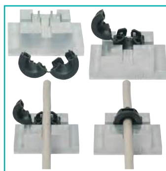
Istruzioni di montaggio con uso di posaggio. Accessorio su richiesta per grandi serie. Cabling instruction with the use of a grill. On demand: useful for large quantities.
