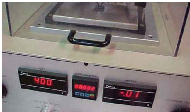
Esempio di prova del filo incandescente Examples of glow-wire test
