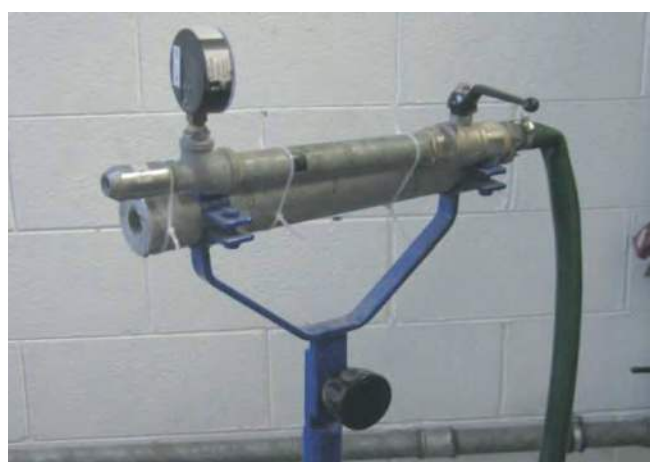
Esempio di test IP66 Examples of IP66 test (NEMKO Test report N. 88143-2TRFENV)
