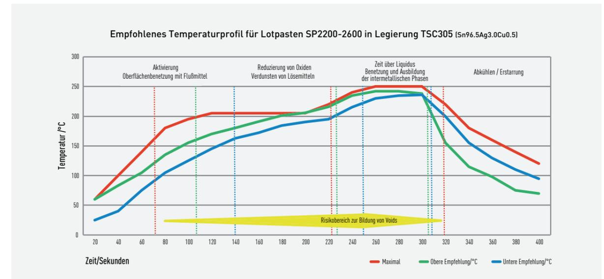
Obwohl sich oftmals neue Pastenentwicklungen leicht in vorhandene Prozesse integrieren lassen kann es je nach Leiterplatte und Bauteilkonfiguration notwendig sein, kleinere Änderungen am Lötprofil vorzunehmen um die gewünschte qualitative Performance des Flussmittels zu erreichen. Als gute Ausgangsbasis kann hierbei mit 25°C für 40-60 Sekunden über Liquidus die Mitte des Prozessfensters zufriedenstellend und größtenteils auch bauteilschonend angesetzt werden.
