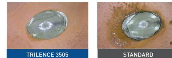
Auf einer Kupferoberfläche ist das unterschiedliche Verhalten der Rückstände bleifreier Lötdrähte gut zu erkennen. Die Trilence-Lötdrähte zeichnen sich durch das geringe Spritzverhalten aus, ihre hellen Rückstände sowie die optimale Ausbreitung.
