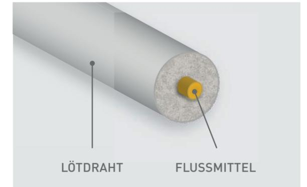
Ein wichtiger Bestandteil der Lötdrähte ist das Flussmittel, welches bei der Entfernung von Oxiden von den zu lötenen Metalloberflächen eine entscheidende Rolle spielt. Stannol Lötdrähte werden standardmäßig 1-seelig gefertigt.
