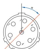
Drehung des Isolierkörpers im Vergleich zu Typ „03“
