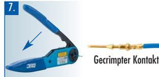
Anschließend crimpen und prüfen, ob der Kontakt ordnungsgemäß gecrimpt ist: Der Draht muss von der Lüftungsöffnung aus sichtbar sein und die Isolierung des Drahtes muss an der Rückseite des Kontaktes anliegen.
