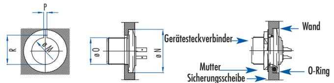
Vor der Montage den O-Ring in die Nut des Ringflanschs des Gerätesteckverbinders einlegen. Anschließend den Gerätesteckverbinder, die Sicherungsscheibe und die Mutter platzieren.
