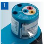
1. Auf den Abzughebel drücken, um den Positionierer zu entriegeln.
