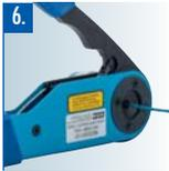
Die abisolierte Litze in die Kontakthülse einführen und dabei über die Lüftungsöffnung sicherstellen, dass sie vollständig eingedrungen ist. Kontakt und Draht vollständig in die dafür vorgesehene Öffnung am Rücken der Zange einführen.
