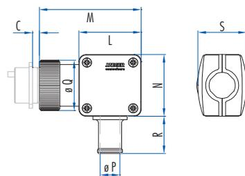
Kabelsteckverbinder und Kupplungssteckverbinder
