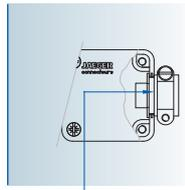
Position der Nut der Kabelklemme in der Schale
