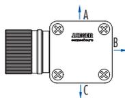
Der Einsatz lässt sich in verschiedenen Positionen im Gehäuse befestigen
