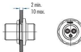
Vor der Montage den O-Ring in die Nut des Ringflanschs des Gerätesteckverbinders einlegen. Anschließend den Gerätesteckverbinder, die Sicherungsscheibe und die Mutter platzieren. Die Dichtigkeit der Montage wird durch den Druck auf die Dichtung zwischen der Wand und der Wanddurchführung erreicht.
