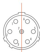
Hauptcodierung identisch mit Typ „normal“, Winkelverschiebung der Sekundärcodierung
