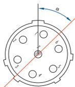
Drehung des Isolierkörpers im Vergleich zu Typ „normal“
