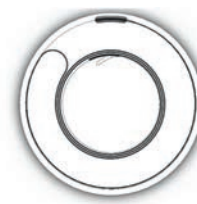
Abb.: Loop-back Clockspring Highflex, Leiterbahn: Cu-PHC (SE-Cu58) 25 µm – 40 µm (Standard 35 µm); Biegewechselfestigkeit > 10Mio Zyklen
