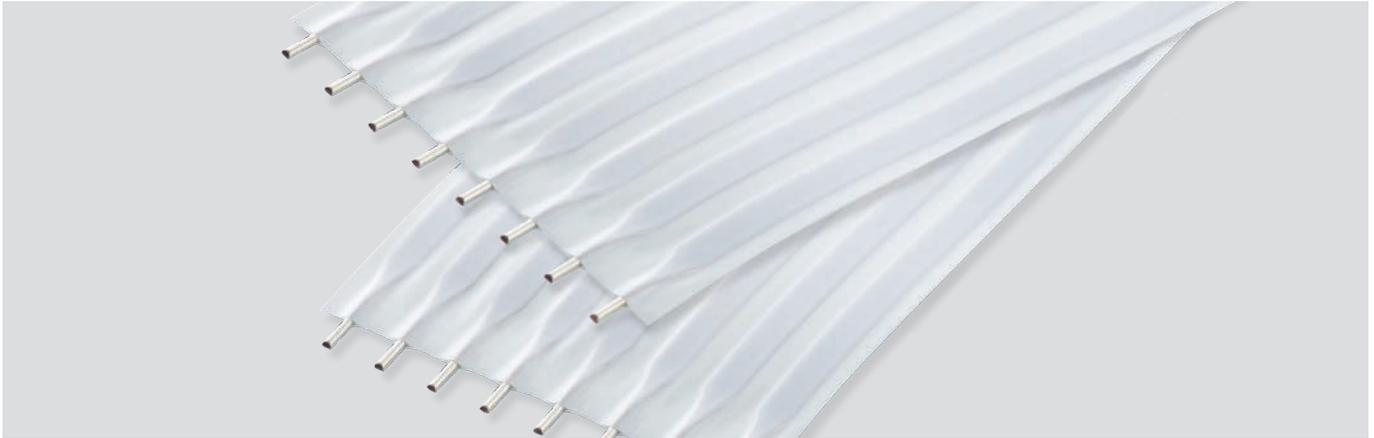
**PANTA<sup>®</sup> FIX POWER JUMPER** sind flexible Flachleiterverbinder, speziell für Applikationen mit Strombelastbarkeit bis 12 Ampere. Durch die PANTA<sup>®</sup> Rund-Flach-Rund Technologie werden die Kupferleitungen im Bereich der Isolation definiert flachgewalzt und garantieren somit höchste Anforderungen an Vibrations- und Biegebeständigkeit. Der fließende und kerbfreie Übergang von rund zu flach garantiert eine bruchssichere Anschlussstelle.
