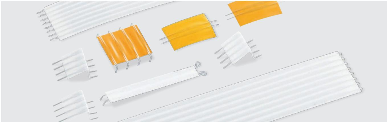
**PANTA FIX JUMPER** sind hochflexible Leiterplattenverbinder. Durch die Kombination der PANTA Rund-Flach-Rund Technologie werden die Kupferleitungen im Bereich der Isolation definiert flachgewalzt und garantieren somit höchste Anforderungen an Vibrations- und Biegebeständigkeit. Der fließende und kerbfreie Über-
