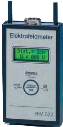
Kleines handliches Elektrofeldmeter mit Digitalanzeige zur Messung elektrostatischer Felder und Aufladungen. Messverstärker nach dem Feldmühlen-Influenz-Prinzip.
