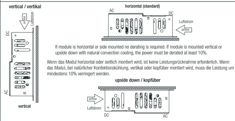
Fig. 2: Derating Graph / Temperaturverhalten
