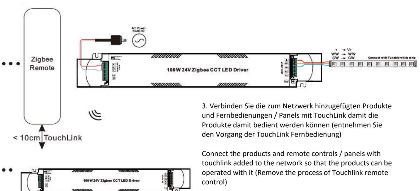
3. Verbinden Sie die zum Netzwerk hinzugefügten Produkte und Fernbedienungen / Panels mit TouchLink damit die Produkte damit bedient werden können (entnehmen Sie den Vorgang der TouchLink Fernbedienung)
