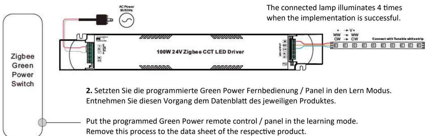
2. Setzen Sie die programmierte Green Power Fernbedienung / Panel in den Lern Modus. Entnehmen Sie diesen Vorgang dem Datenblatt des jeweiligen Produktes.
