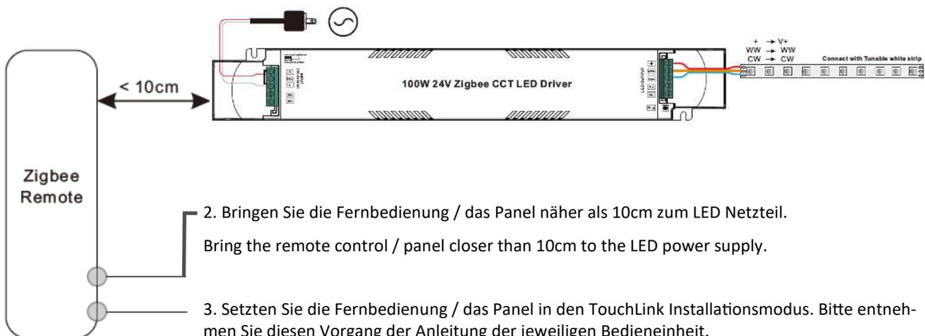
2. Bringen Sie die Fernbedienung / das Panel näher als 10cm zum LED Netzteil.
