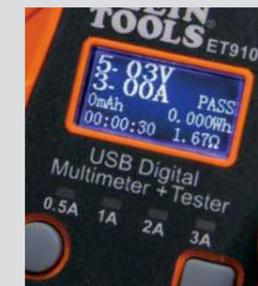
Das rote LED-Anzeigelicht erlischt und „PASS“ (BESTANDEN) oder „FAIL“ (NICHT BESTANDEN) wird nach Abschluss der Prüfung auf dem Display angezeigt.
