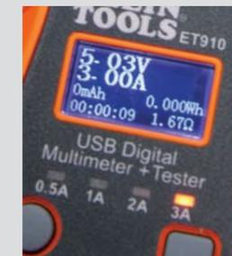
Drücken Sie die Taste „Test Load“ (Prüflast) mehrmals, um zwischen den Stromstärkenprüfungen zu wechseln. Das rote LED-Anzeigelicht leuchtet konstant und zeigt die Stromstärkenprüfung an.
