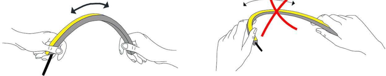
Biegen Sie das Profil nur in die angegebene Richtung. Bei Nichtbeachtung der angegebenen Hinweise wird die elektrische Funktionalität des Produkts beeinträchtigt. Verdrehen Sie den IP Flex nicht.
